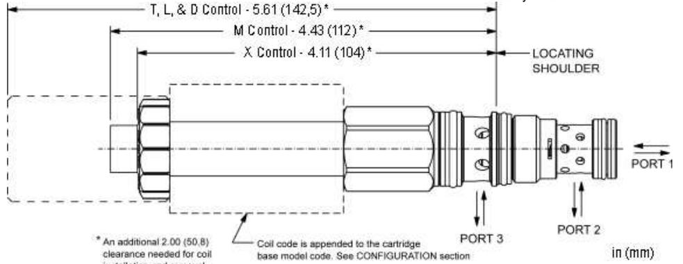
此2位3通磁直式，。此断1口和2口通，3口封，通2口和3口通，1口封。所有流道都可双向通流。与FLeX系列圈配合使用。由于，此泄漏极低。
